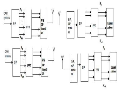
Fig2. MIMO-OFDM Traansreceiver
